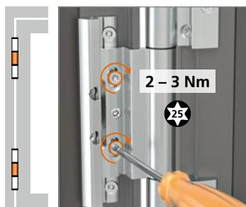
Verstellung kann je nach Einbausituation geringer ausfallen. Le réglage peut, selon la situation de montage, être plus faible.
